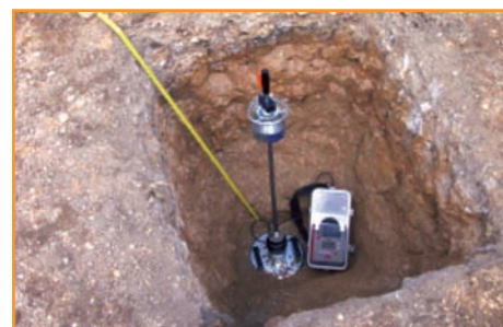
[Fig. 12] .- Reconocimiento geotécnico en calicata.
