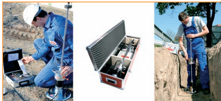
[Fig. 11].- El ZFG3.0 puede determinar el grado de compactación del terreno tanto en cimentaciones como en zanjas.
