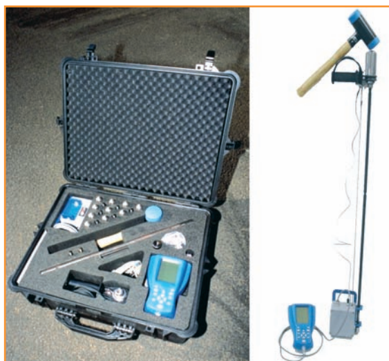
[Fig. 1].- Penetrómetro ligero a energía variable Panda 2 .
