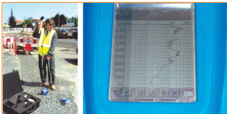
[Figura 2].- El procesado de los datos adquiridos con el PANDA2, permite crear distintos gráficos de los mismos.
